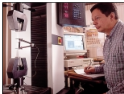
Dragprovning av basmaterial.
