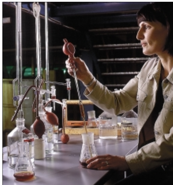
Våtkemisk kontroll vid förbehandling av plåten inför målning.
