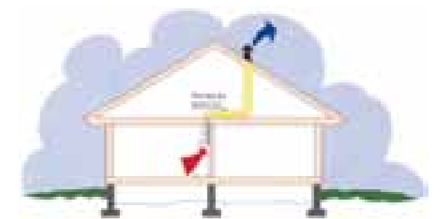
Principskiss över kanaldragning från köksfläkt.
