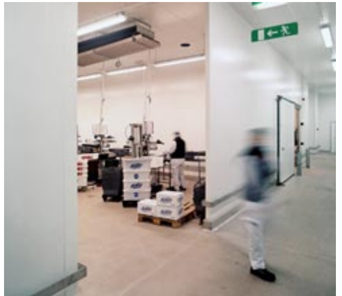
Plannja Panel 200. Saumat tiivistetään huolellisesti, mikä estää lämmintä ja kosteaa ilmaa tiivistymästä kylmätilan sisäpuolelle. Plannja Panel, jossa on eristeenä EPS (paisutettu polystyreeni), on luonnollinen valinta hyvän lämmöneristävyytensä ja taloudellisuutensa ansiosta. Tässä pystyasennettu kirkkaanvalkoinen Plannja Panel.
